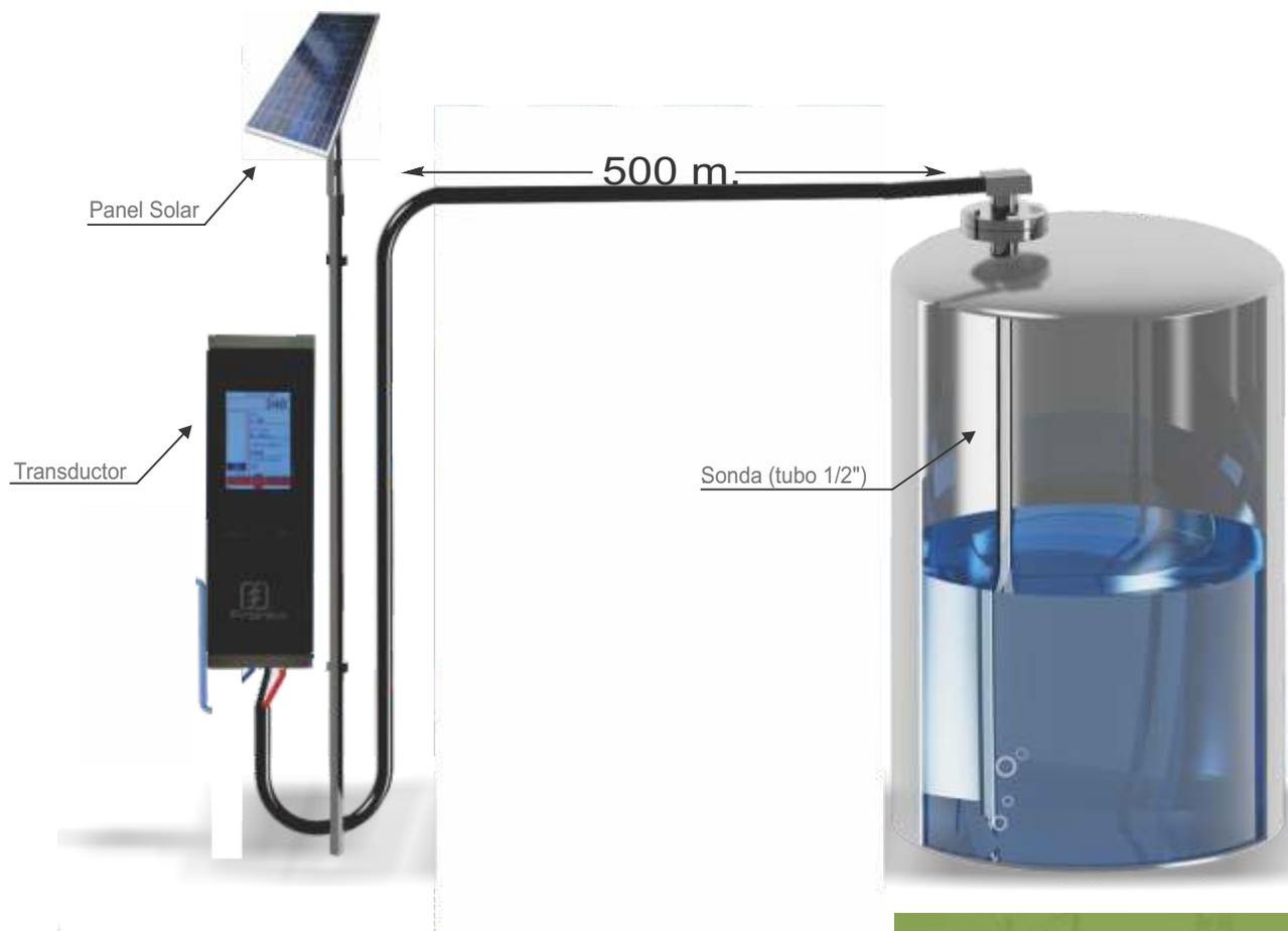
Compacto, preciso y seguro, puede ser utilizado en aplicaciones donde otro tipo de indicadores de nivel no funcionarían, como en ácidos muy corrosivos, asfaltos expuestos a elevadas temperaturas, solventes muy volátiles, líquidos de alta viscosidad como miel de abeja, melaza, resinas de pintura entre otros. Como su sistema de operación es neumático, es muy confiable, sobre todo en escenarios y aplicaciones de alto riesgo.
